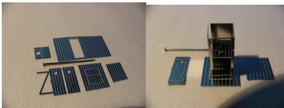
2. - Seitenwand 3mal biegen (90 Grad), auf Stoß verlöten, ggf. ausrichten
