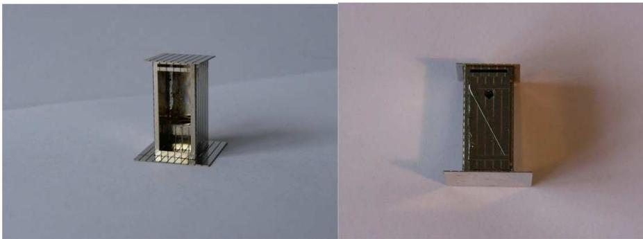
5. - Dach auf den Seitenwänden auflöten
